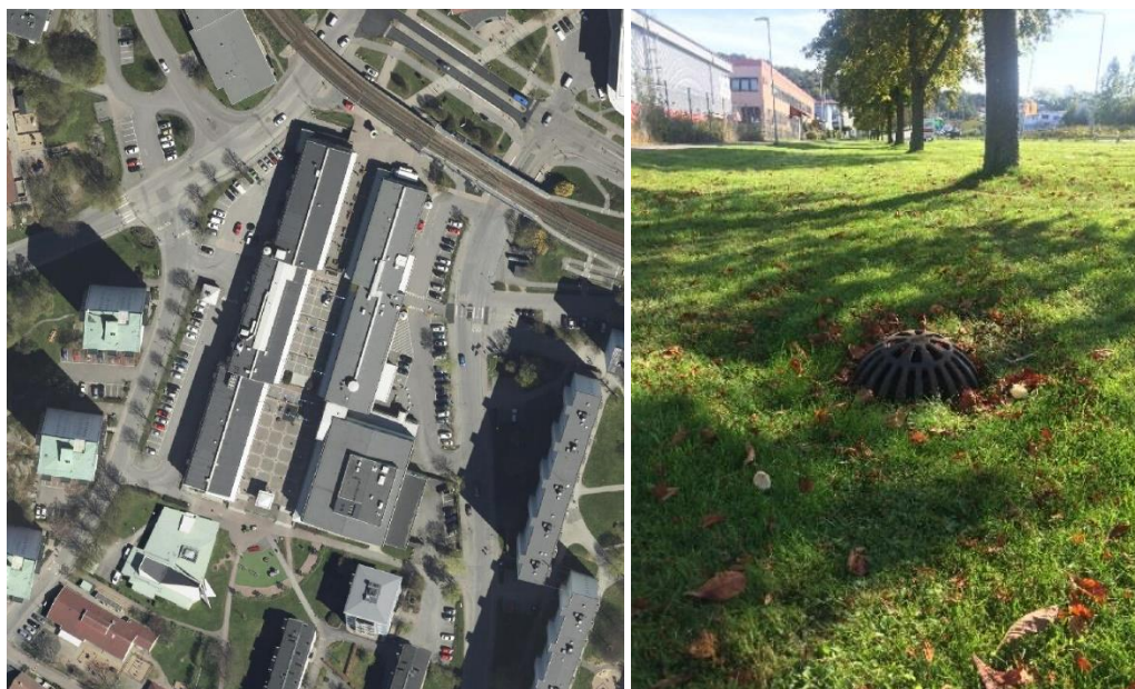
Figur 3. Bilden till vänster visar Vårväderstorget som är ett exempel på en medelbelastad yta. Bilden visar exempel på en översilningsyta som är en lämplig reningslösning i denna typ av område.
