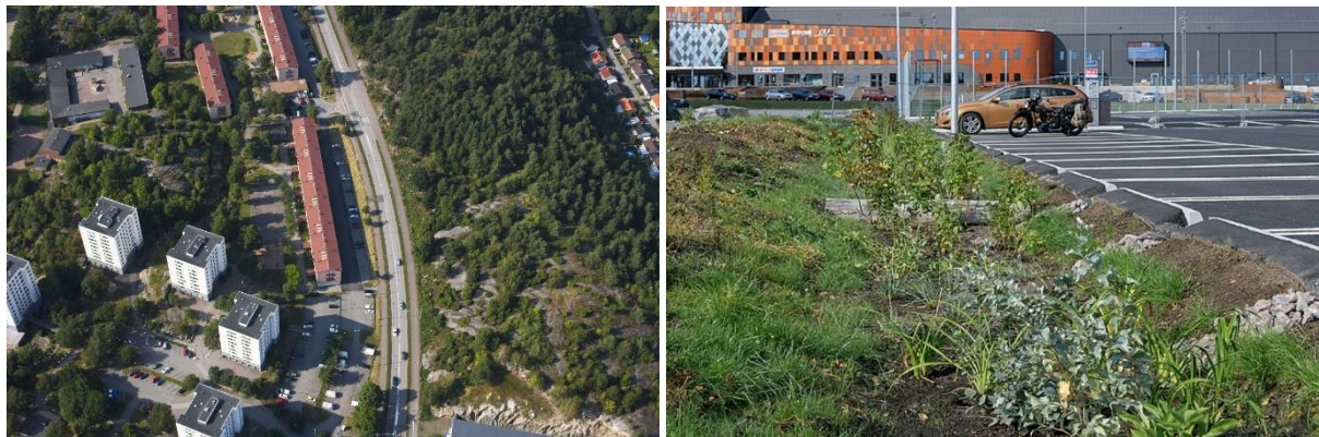
Figur 4. Bilden till vänster visar Sommarvädersgatan som är ett exempel på en hårt belastad yta. Längs en lång sträcka finns grönremsor som har potential för att utnyttjas till fördröjning och rening av dagvatten. Till höger visas en bild på regnbädden vid Kvibergs arena. Liknande lösningar kan anläggas i anslutning till hårt belastade ytor.
